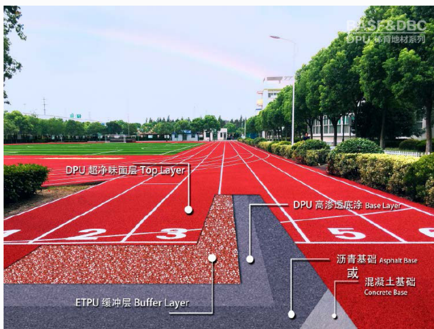
ETPU混合EPDM缓冲层 有效提高冲击吸收性能
